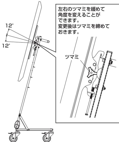
左右のツマミを緩めて角度を変えることができます。変更後はツマミを締めておきます。
