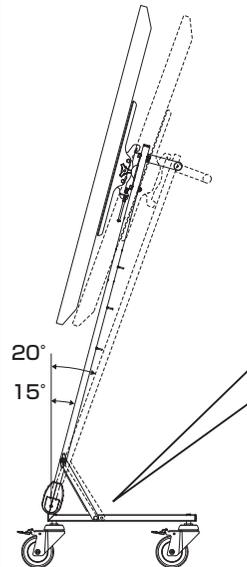
ストッパーを後の穴に付け替えると、スタンドの角度を15°から20°に変えることができます。裏側のナットをスパナで緩めて、ボルトを付け替えます。変更後はナットを締めておきます。
