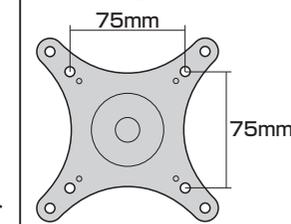
※ネジ穴ピッチ 100mm×100mmの場合 外側の穴を使います。
